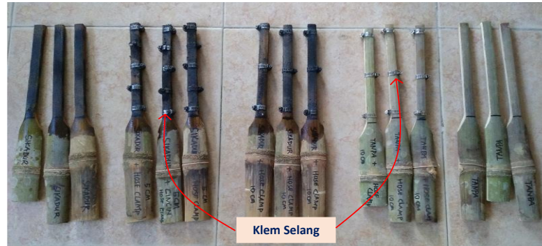
Gambar 5. Tulangan bambu dengan treatment pelaburan perekat, pelaburan pasir, dan klem selang
