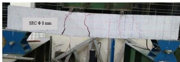
**Gambar 10.** Pola retak balok beton bertulang baja (SRC)
