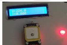
Gambar 11. Tampilan data pada LCD 16x2 dan LED
