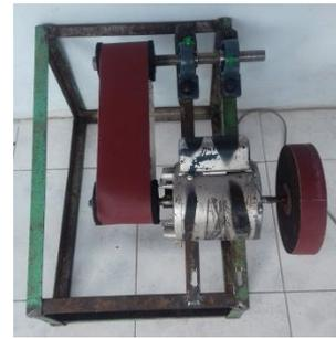
Gambar 7. Tampilan Mesin Penghalus Tipe *Disc* dan *Belt*
