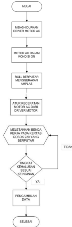
Gambar 5. Diagram Alir Proses Kerja Mesin
