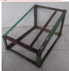
Gambar 6. Desain Rangka Mesin Penghalus
