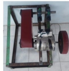
Gambar 7. Tampilan Mesin Penghalus Tipe Disc dan Belt
