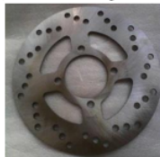
Gambar 3. Piringan dengan Jumlah 36 Lubang (dokumentasi pribadi)
