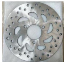
Gambar 4. Piringan dengan Jumlah 40 Lubang (dokumentasi pribadi)
