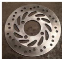
Gambar 2. Piringan dengan Jumlah 30 Lubang (dokumentasi pribadi)
