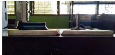
Gambar 1. Sambungan Kampuh V
