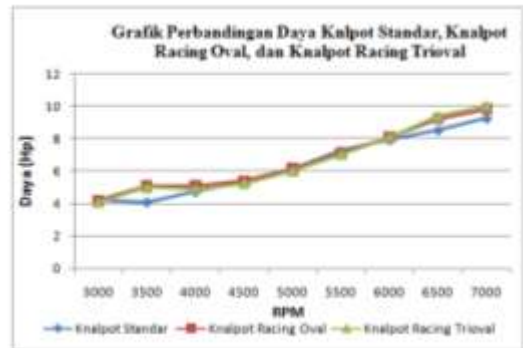
Gambar 6 Grafik Perbandingan Daya knalpot Standar, Knalpot Racing Oval, dan Knalpot Racing Trioval
