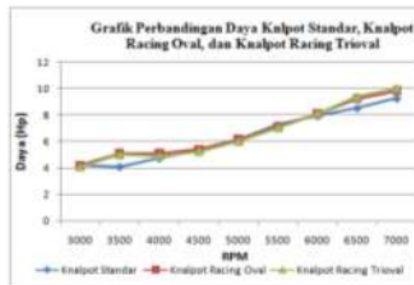
Gambar 6 Grafik Perbandingan Daya knalpot Standar, Knalpot Racing Oval, dan Knalpot Racing Trioval
