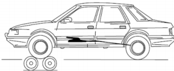
Gambar 1. Uji Rem Statis
