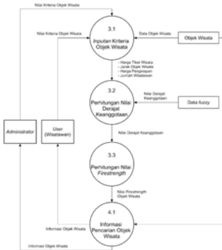
Gambar 4. DFD Level 2 Proses Perhitungan Derajat Keanggotaan
