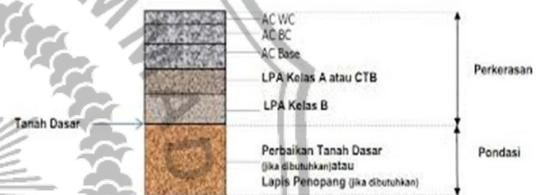
**Gambar 3.** Struktur Perkerasan (Bina Marga Tahun 2013)
