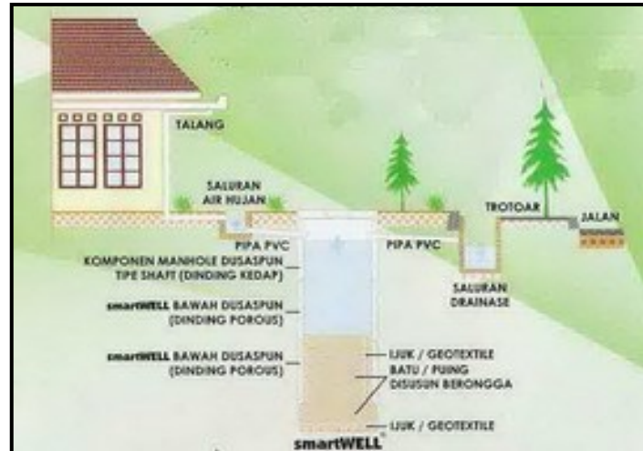
Gambar 5.6. Konstruksi Sumur Resapan SMARTWELL
