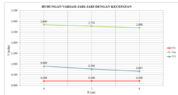
Gambar 15. Grafik Hubungan Antara Variasi Jari - jari (cm) dengan Kecepatan Aliran V (m/det) hasil uji lapangan Sumber : Pengolahan data 2021
