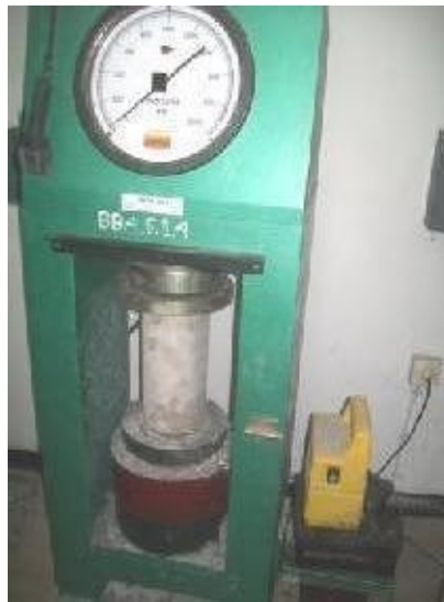
Gambar 2.2. Ilustrasi Pengujian kuat tekan silinder beton
