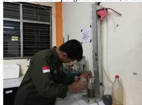
**Gambar. 25.** Uji test Permeabilitas Tanah. (Sumber : Hasil pengolahan data, 2022)
