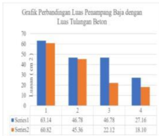
Gambar 4. Perbandingan Luas Penampang Baja dengan Luas Tulangan Beton
