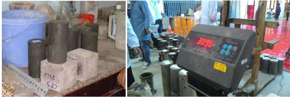
Gambar 4.3. Curing dan perawatan beton ringan di Laboratorium
