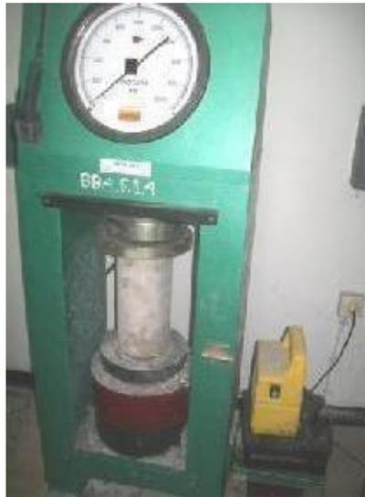
Gambar 3.2. Ilustrasi Pengujian kuat tekan silinder beton
