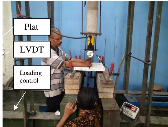
**Gambar 4.** Pembebanan Pada Plat Beton
