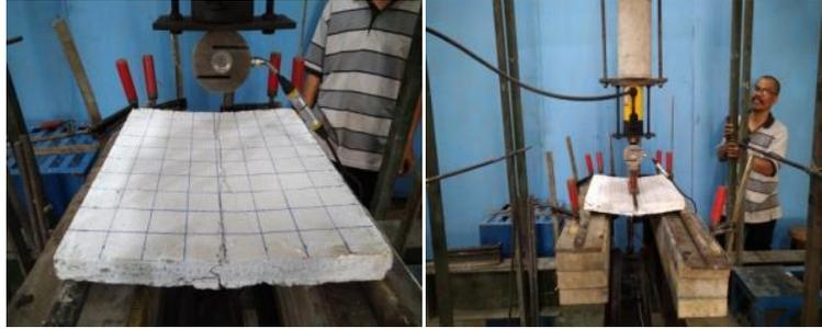
**Gambar 6.** Proses pengujian dan retakan yang terjadi saat pengujian
