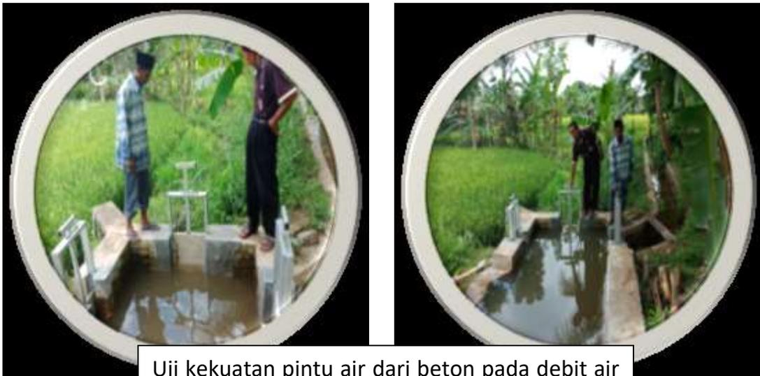
Uji kekuatan pintu air dari beton pada debit air irigasi kondisi rata-rata dan debit penuh
