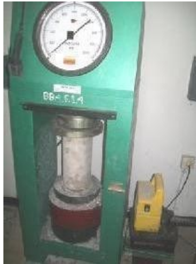
Gambar 2.2. Ilustrasi Pengujian kuat tekan silinder beton
