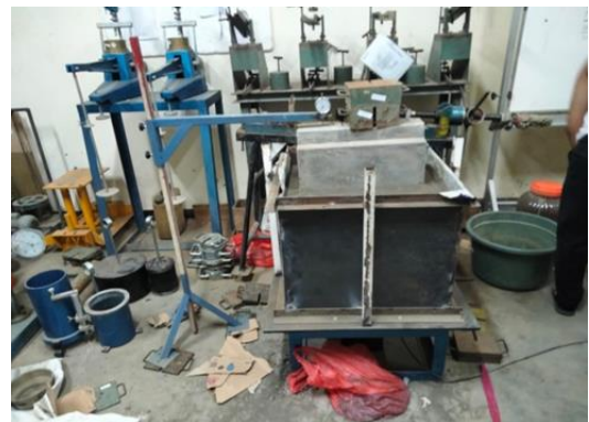
Gambar 4. Pemodelan pengujian abutment dengan menggunakan shaking table .
