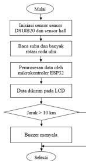
Gambar 5. Flowchart cara kerja alat
