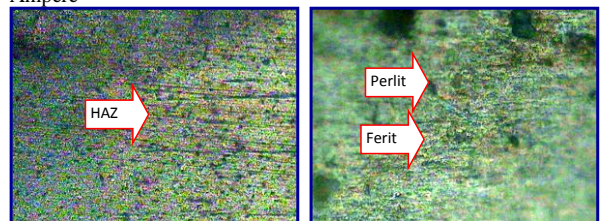
Gambar 4.27 (Spesimen 3) Foto Mikro perbesaran 50 x pada HAZ dan 200x pada Weld Metal , pada kampuh 80 0 dengan arus 100 Ampere
