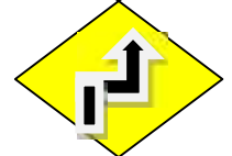
Gambar 5.15 Rambu Jalan Peringatan Tikungan
