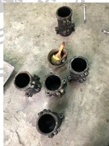
Gambar 3. 4 Proses Pengolesan Pelumas Pada Mold
