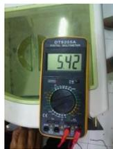
Gambar 3.1 Pengujian Catu Daya 5V
