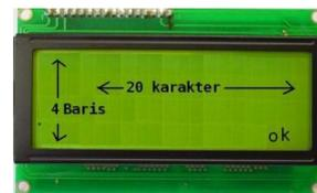
Gambar 2.8 Bentuk Fisik LCD
