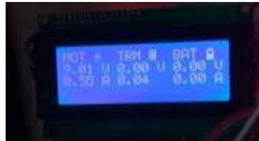
Gambar 3.3 pengujian sensor Arus ACS 712
