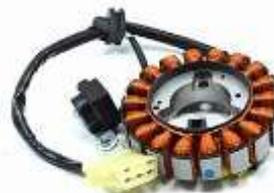
**Gambar 2.2** Generator atau spull pada sepeda motor
