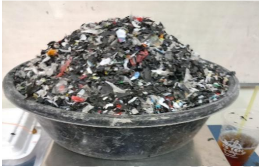
Kegiatan pengumpulan dan pengacahan limbah sampah plastik LDPE dengan ukuran \pm 1 cm
