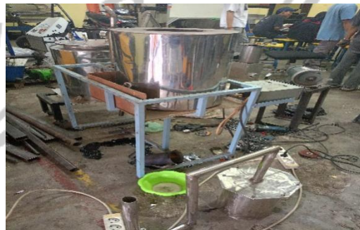
Proses pengangkatan tabung reaktor pirolisis setelah proses pendinginan
