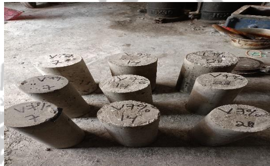
Pengangkatan benda uji silinder setelah proses curing
