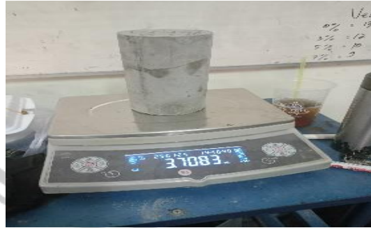
Menimbang berat isi benda uji silinder beton
