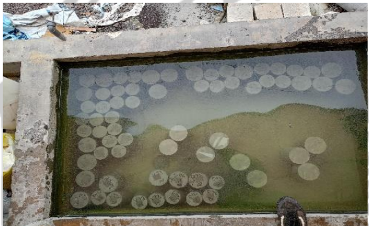
Proses perawatan benda uji dengan proses curing dengan variasi curing selama 7, 14, dan 28 hari
