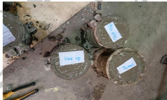
Proses memasukkan bahan material yang sudah tercampur ke dalam mould silinder
