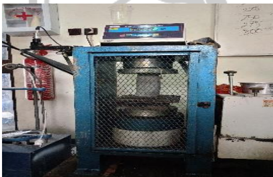
Pengujian kuat tekan beton dengan menggunakan mesin Compression Testing Machine (CTM)
