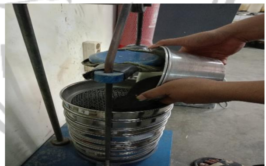
Pengujian karakteristik agregat residu LDPE sebagai substitusi agregat halus
