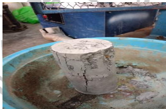
Kondisi keretakan benda uji setelah uji kuat tekan beton
