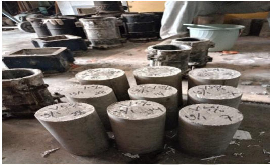
Pemberian keterangan variasi pada setiap benda uji silinder yang telah di diamkan selama 24 jam
