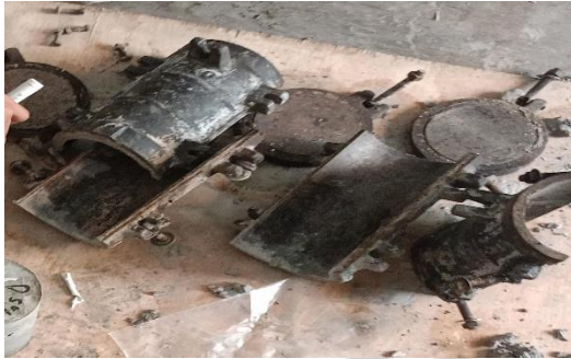
Kegiatan menyiapkan mould silinder ukuran 100mm x 200mm dan pemberian oli pada mould
