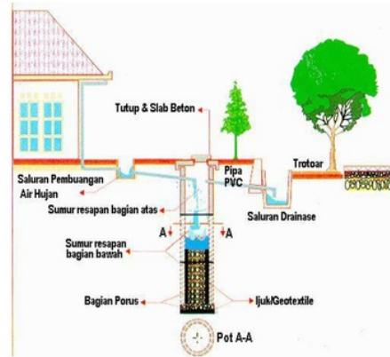
Gambar 1. Contoh pot A-A sumur resapan pada perumahan
