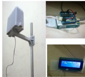
Gambar 5. Rancangan alat untuk modifikasi stasiun hujan lengkap dengan mikrokontroler dan LCD.
