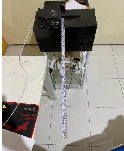
Gambar 4.3 Pengujian Sensor Ultrasonik
