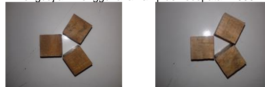
Pengujian menggunakan amplas kecepatan 1500 RPM
