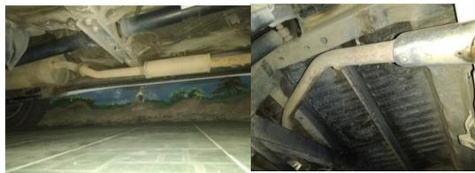
Gambar 4. 36 Sistem Pembuangan Mobil Transmisi Manual
