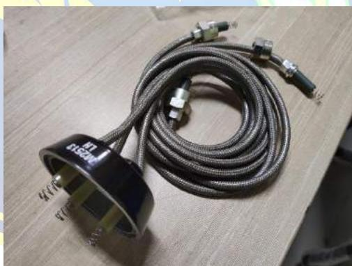
Distributor Harness untuk penyalur tegangan listrik dari magneto
