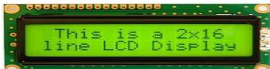
Gambar 2.2 Bentuk LCD ( Liquid Crystal Display )
