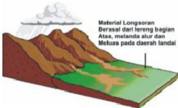
Gambar 2. Skema Tanah Longsor Dataran Tinggi
