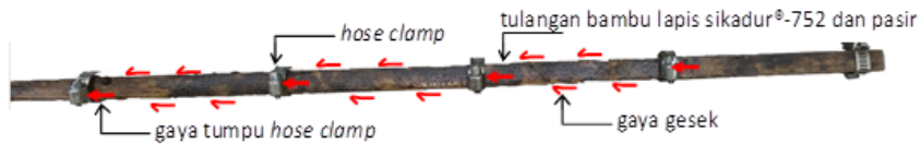
Gambar 1.7. Gaya gesek dan gaya tumpu pada tulangan bambu bercincin klem-selang
