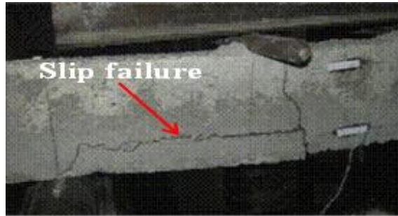
Gambar 1.5. Rambatan retak beton bertulang bambu Sumber: Agarwal, Nanda, & Maity (2014, p.616)
