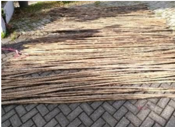
Gambar 5.4. Pengeringan bambu pada udara bebas sampai kadar air \pm 12%.
