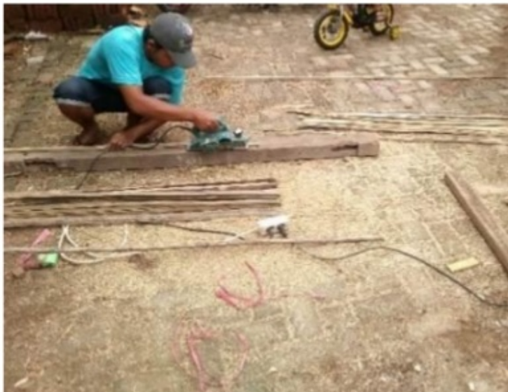
Gambar 5.5. Pengelupasan bagian dalam sesuai dimensi rencana tulangan bambu
