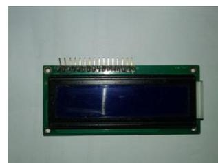
Gambar 2.6 Bentuk fisik LCD (*liquid crystal display*) 16 x 2
