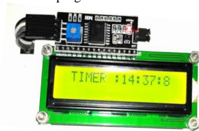
Gambar 4.11 Tampilan Timer Pada LCD ( Sumber : www.aliexpress.com )
