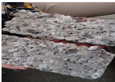
Gambar 10. Benda Uji Beton Berpori Setelah Pengujian Kuat Tarik Belah
