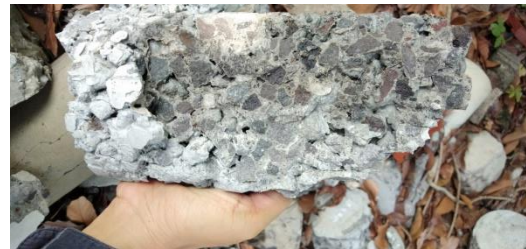
Gambar 8. Benda Uji Beton Berpori Setelah Pengujian Kuat Tekan
