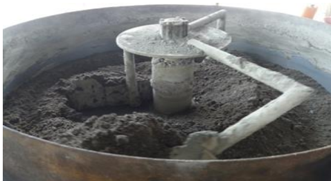
Gambar.1 Pembuatan batako yang diisi sabut kelapa
