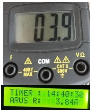
**Gambar 4.7** Kalibrasi Sensor Arus Non-Invasive pada Phase R.
