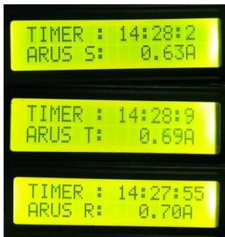
**Gambar 4.11** Tampilan Pengujian Sensor Pada LCD RST.
