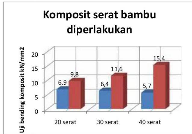
Gambar: 3.5 Grafik rata – rata Kekuatan Bending komposit serat bambu tali (gigantochloa apus) yang tanpa diperlakukan perendaman (NaOH) dan diperlakukan 120 menit
