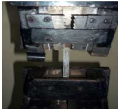
Gambar 1. Uji tarik material Komposit di mesin
