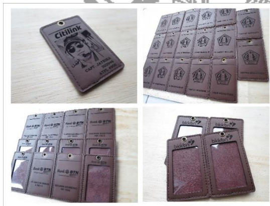
Gambar 7. Contoh produk yang sudah dilakukan grafir dengan mesin laser
