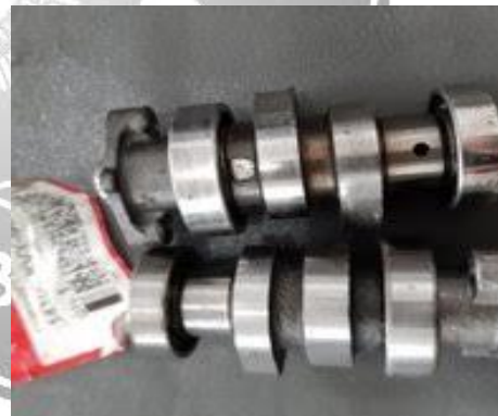
Gambar 3 Camshaft Standart dan Camshaft Racing Honda Beat 110.cc Tahun 2016
