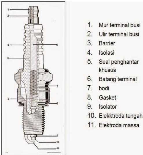
Gambar 13. Konstruksi busi
