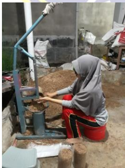
Gambar 13. Pengepresan dengan pres baglog manual
