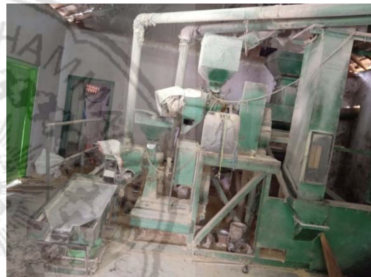
Peneliti bersama responden usaha penggilingan padi skala menengah di Kecamatan Kendit dengan kapasitas mesin penggilingan padi 1 ton giling gabah per jam.
